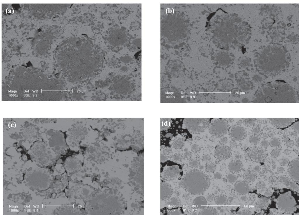
**Fig. 4.** SEM micrographs of amalgam/ TiO<sub>2</sub> NPs nanocomposites (a) 0.5 wt. % , (b) 1 wt. % , (c) 2 wt. % and (d) 3 wt. % of TiO<sub>2</sub> NPs.
