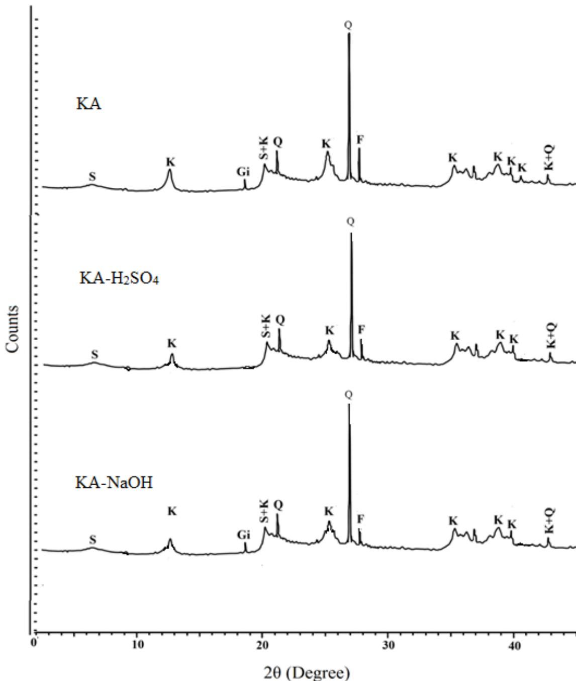
Fig. 1. XRD scans of clay samples. A KAO: B KAO-H<sub>2</sub>SO<sub>4</sub>: C KAO-NaOH.
